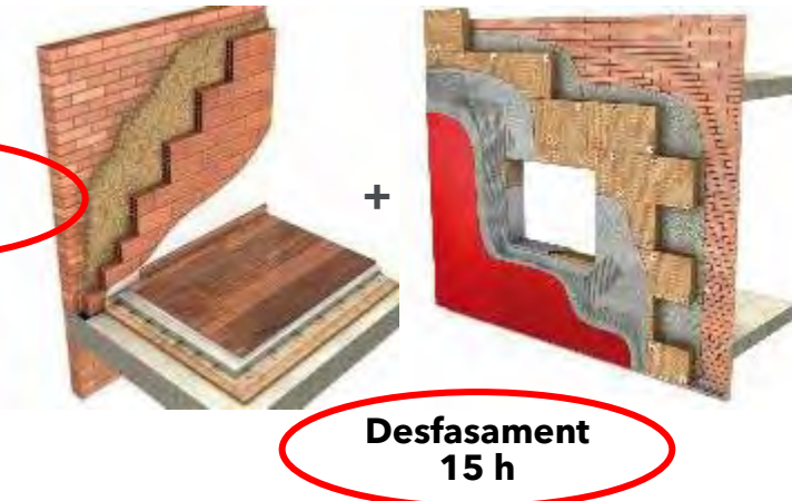
Insuflat en cambra d'aire 10 cm + SATE 10 cm
